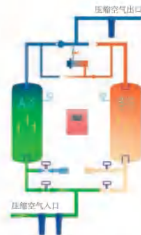
微热吸附式干燥机工作原理图
